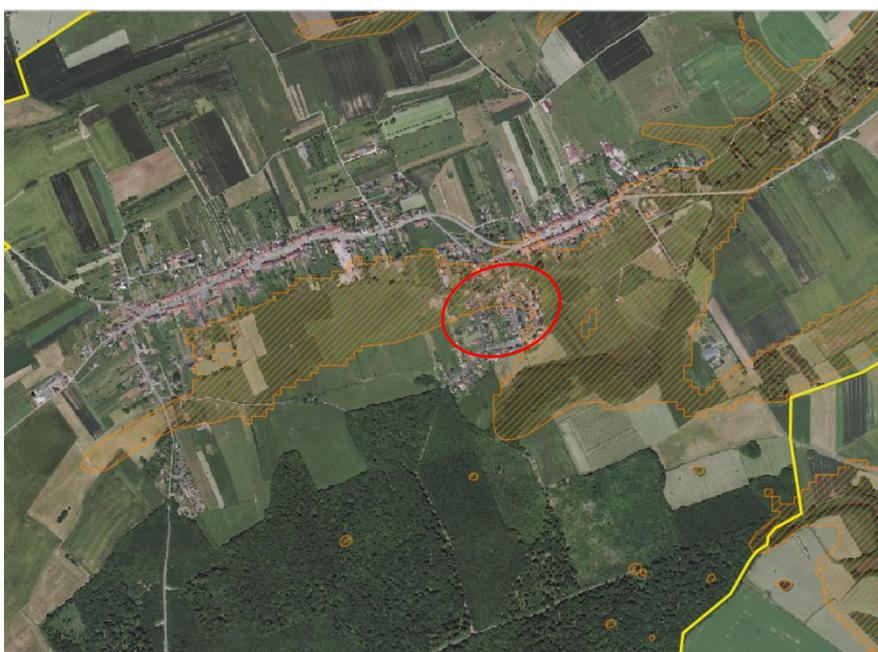
Schéma 8 : Enveloppe approchée des inondations potentielles par débordement de cours d'eau.
