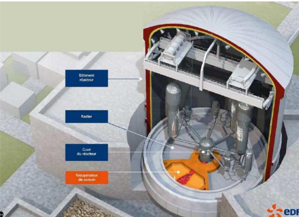
**Ausbreitungsvorrichtung für das Corium in einem speziellen Auffangbereich unter dem Reaktordruckbehälter.**
