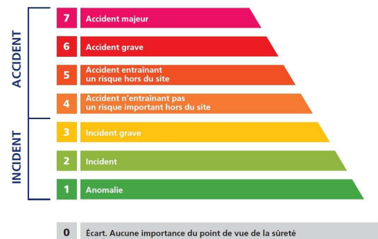
ÉCHELLE INES Échelle internationale des événements nucléaires
