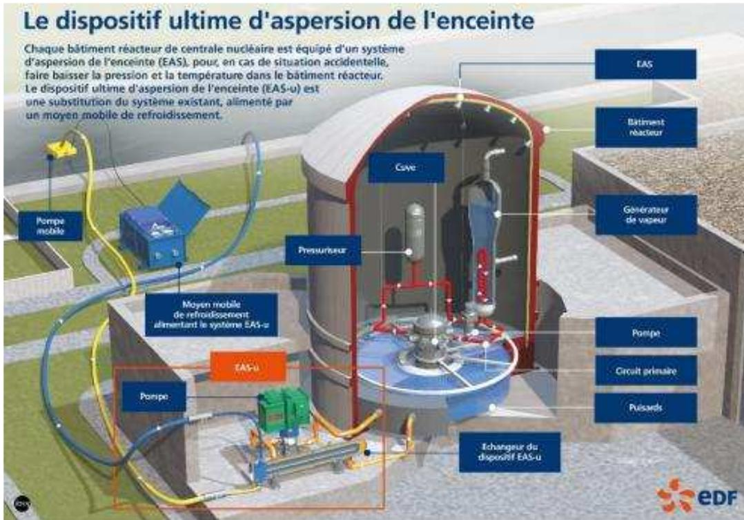
**Finalité :** éviter l'ouverture du dispositif de décompression/filtration de l'enceinte durant un accident avec fusion du cœur et ainsi éviter d'imposer des mesures de protection de la population (2km pour l'évacuation, 5 km pour la prise d'iode).
