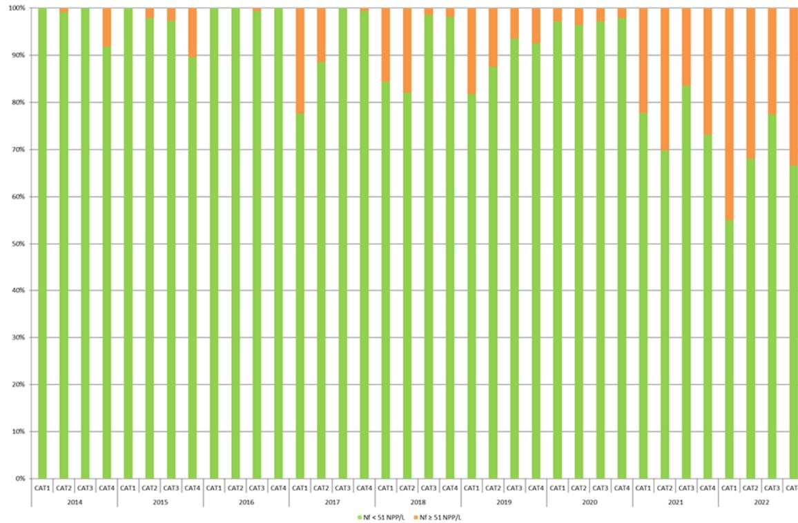
Répartition (en pourcentage) des concentrations en Nf mesurées dans les CRF entre 2014 et 2022 sur les quatre réacteurs de Cattenom (2022 de janvier à octobre) (supérieure ou pas au seuil de quantification de 51 Nf/L)
